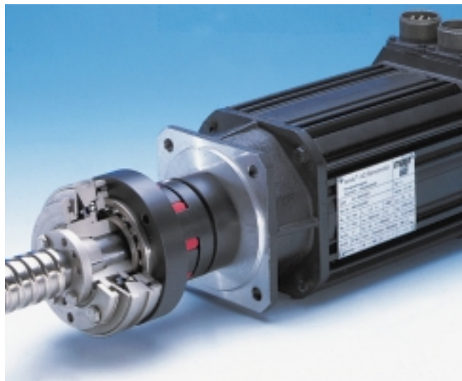
EAS ® -NC lastic spielfrei in direktantriebener Servoachse. Diese Kombination begrenzt das Drehmoment exakt auf den eingestellten Wert, gleicht Wellenverlagerungen aus und dämpft kritische Resonanzschwingungen.
